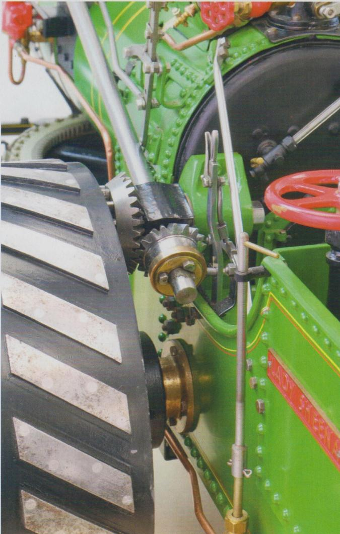
Blick auf den hinteren unteren Teil der herabstürzenden Welle: Der kleine Handhebel dient um durch eine Verschiebung des angesteuerten großen Konus­zahn­rades den Kraftschluss Welle/Hinterrad und damit der Achsantrieb ein und ausschalten zu können. Der kleine Drehhebel hinten ist die Bedienung des unten leicht sichtbaren Injektors
