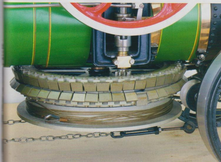
Detailansicht der Seiltrommel: oben clip drum verantwortlich für das durchlaufende Seil, darunter fest verbunden eine übliche Seiltrommel zum Spulen
