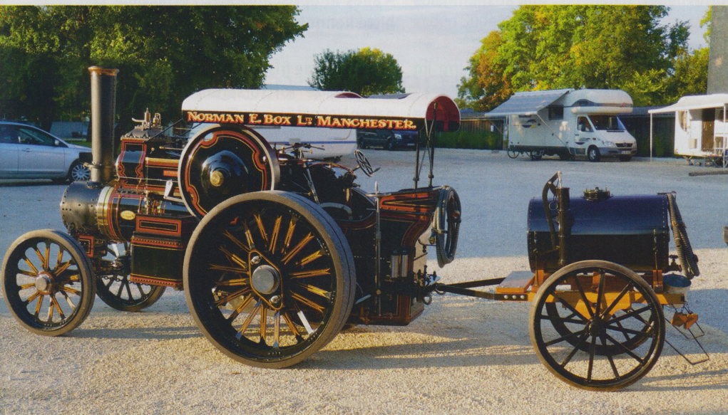
▲ Das inzwischen wohl perfektteste mir bekannte Modell der berühmten Fa. Norman E. Box aus Manchester mit zeitgenössischem Wasserwagen samt angeflanschter funktionsfähigen Wasserpumpe; vor dem Hinterrad der Bauchtank und darauf die originalgetreue Werkzeugkiste
