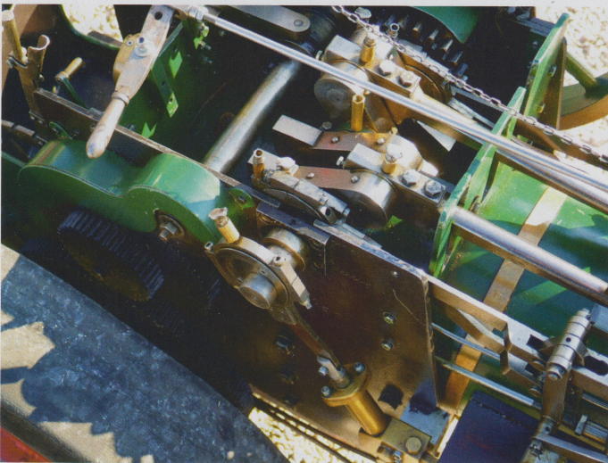
Freelance Modell: Triebwerksblick von oben: zwischen Hinterrad und Frontplatte: vorn mechanische Wasserpumpe dahinter der Abtrieb der zweiten zur dritten Welle; Schwungrad; 2-zylindrige, massige fein ausbalancierte Kurbeln in 90°-Stellung
