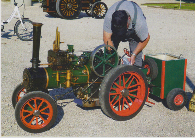
Freelance-Modell, Zweizylinder; mit linksseitiger Dampfspeisewasserpumpe die auch bei Maschinenstillstand fördert; davor Verdrängungsöl; Mehrklangpfeife auf dem Zylinder; dahinter die mechanische Ölpumpe; Sitzanhänger mit innerem Stauraum und Hängerreserverad
