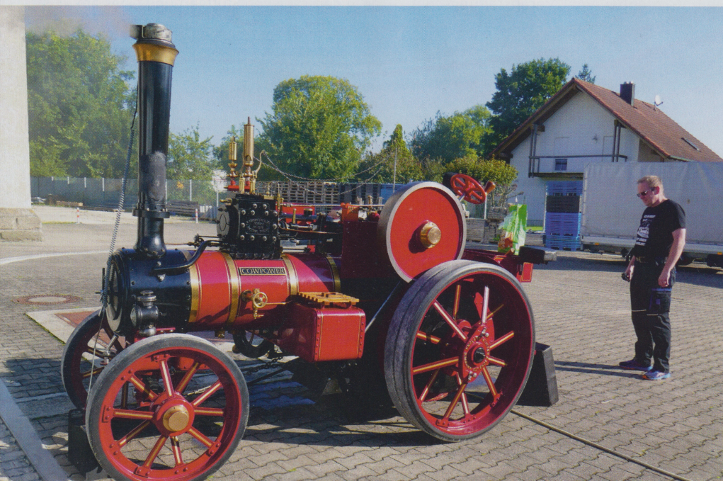
▲ Das inzwischen wohl perfektteste mir bekannte Modell der berühmten Fa. Norman E. Box aus Manchester mit zeitgenössischem Wasserwagen samt angeflanschter funktionsfähigen Wasserpumpe; vor dem Hinterrad der Bauchtank und darauf die originalgetreue Werkzeugkiste
