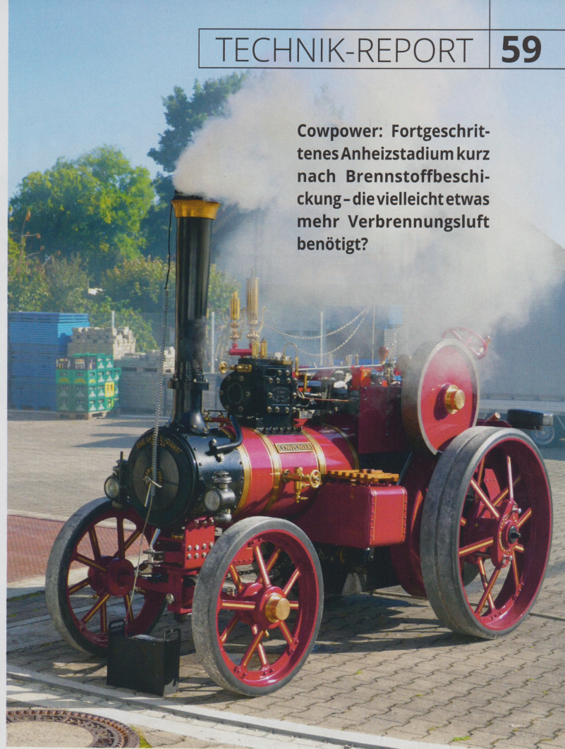
Freelance-Modell, Zweizylinder; mit linksseitiger Dampfspeisewasserpumpe die auch bei Maschinenstillstand fördert; davor Verdrängungsöl; Mehrklangpfeife auf dem Zylinder; dahinter die mechanische Ölpumpe; Sitzanhänger mit innerem Stauraum und Hängerreserverad
