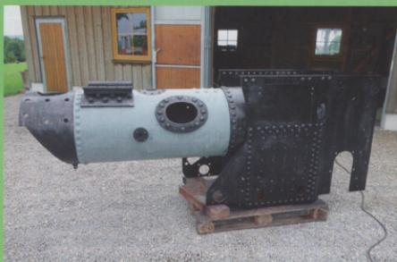
Bild 6: Zur Untersuchung durch den TÜV vorbereitete Kessel.
