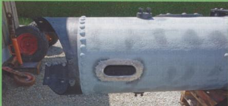
Bild 7: Schadstelle am Boden des Langkessels.
