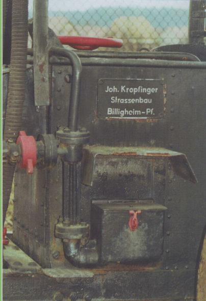
Namensschild der Straßenbaufirma; die Wasserleitung am Wasserheber führt links zum noch vorhandenen Wassersaugberschlauch; die Leitung von oben ist die Dampfzufuhr des Hebers. Dies ist eine Dampfstrahlpumpe ohne mechanische Teile.
