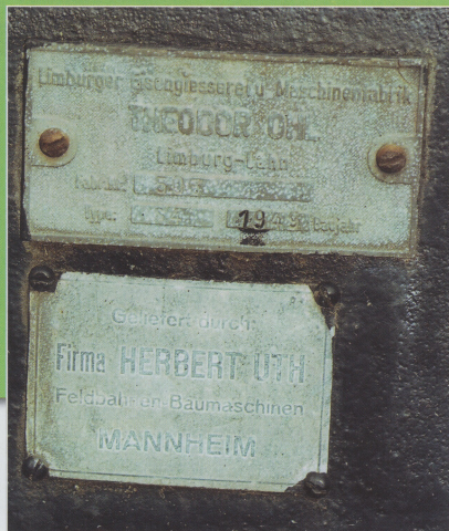
Maschinenschild, gegossen aus Aluminium, des Straßenaufreißers der Firma Theodor Ohl, Baujahr 1949; darunter die Lieferfirma Herbert Uth, Feldbahnen und Baumaschinen in Mannheim.
