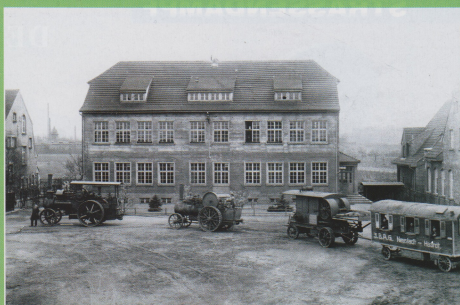
Straßenlokomotive 2-Zylinder mit Schwungradregler, dahinter Dampftraktor 1-Zylinder; dahinter Steinbrecher-Selbstfahrer mit Explosionsmotor und Wohnanhänger.
