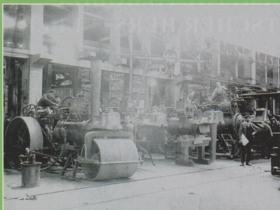
In der Kesselprüfungshalle: vorn links die Druckpumpe; rechts der strenge Kesselprüfer mit der Protokollmappe!
