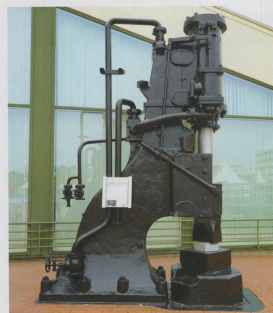
Mittelschwerer Dampfhammer der Firma Brinkmann aus Witten von 1905; Masse 37 t; zum Schmieden von Schiffskurbelwellen und Zylinderkopfmuttern
