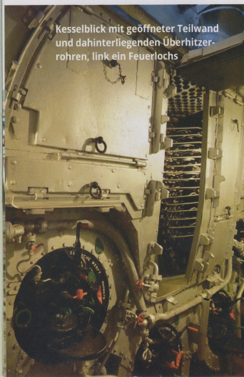
Kohlegefeuerter zweizügiger Ersatzkessel der Meissen; Kohleverbrauch 250 kg/h; 10 bar; Wassertemperatur dabei etwa 170 Grad; diese schottische Bauart wurde aufgrund des großen Inhaltes als wasserträg bezeichnet. Der Kessel wurde in der Regel nur zur Winterpause und bei Reparaturen heruntergefahren
