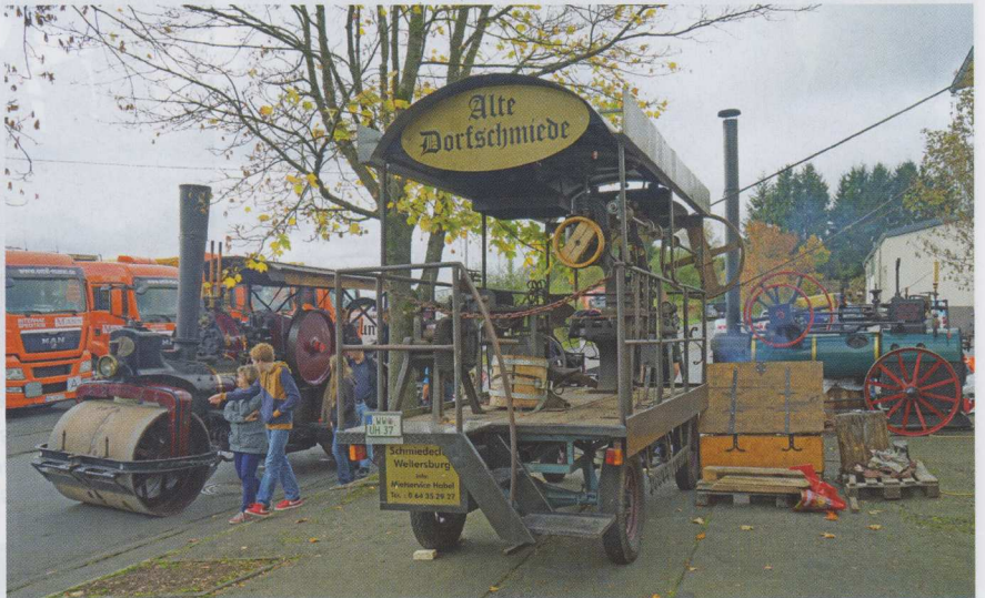
Vor der historischen Schmiede die Neuerwerbung Julia; rechts daneben der Arbeitswagen des Welterburger Schmiedeclubs; rechts daneben die gemeinsame Antriebslokomobile für Schmiede und Arbeitswagen mit Antriebsriemen durchs Fenster.
