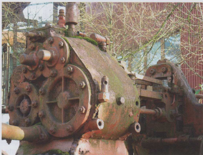
Blick auf den Zylinderblock von vorn Niederdruckseite, ein Überdruckventil demontiert, selbst langfristig verminderte Korrosionspuren dank Rostschutzlackierung.
