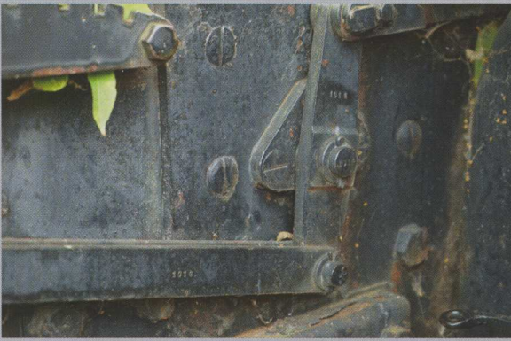
Saubere Nummerierung aller Teiler per Fabriknummer, hier auf der Umsteuerung.
