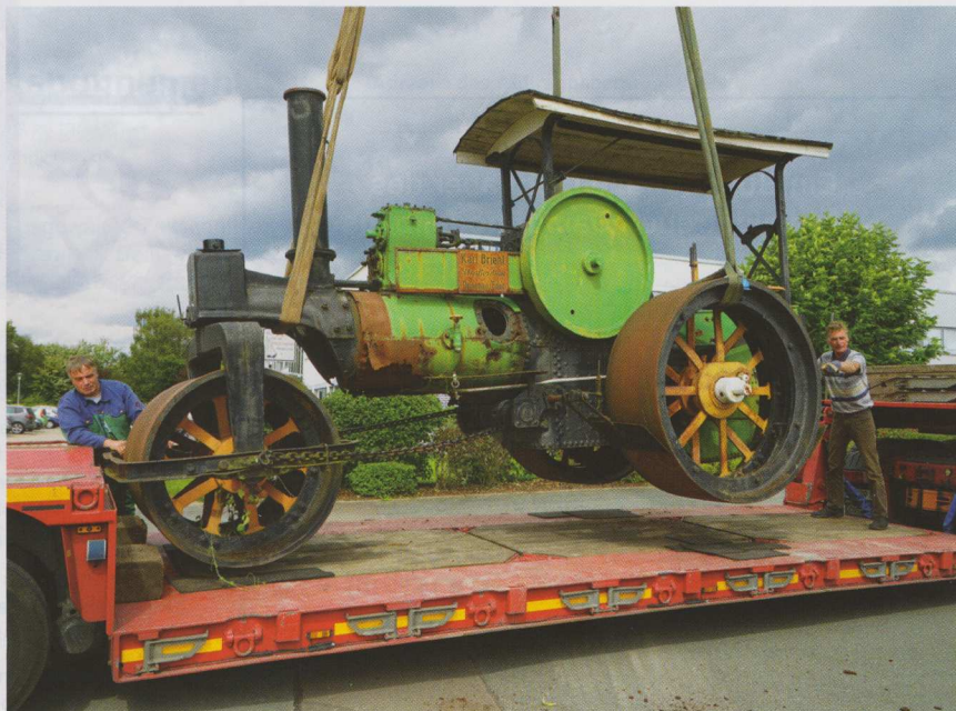
Einchecken der Vorderwalze, die keinesfalls mit der Vordergabel während der Fahrt den Anhänger berühren darf!
