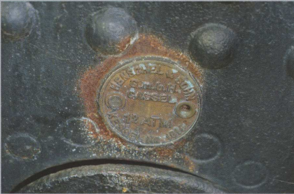
Kesselschild der 1014 über dem Feuerloch; Arbeitsdruck 12 Atmosphären.
