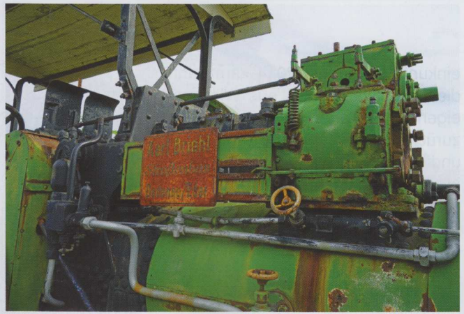
Ansicht von rechts vorne: bereits sichtbar die gerade gelösten Muttern des Zylinderdeckels. Erstaunliche Vollständigkeit der Maschine – nach so langer Zeit auf freiem Felde!
