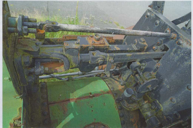
Ansicht auf das Triebwerk: gut sichtbar unten rechts der Rest der Ölpumpe, die Ventilsteuerstange vorn; dahinter die Kreuzkopfführung, darüber die Stange des Dampfreglers.
