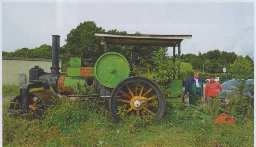
Etwa 15-jähriger Standplatz im Freien mit fast überwachsenem, schwerem Aufreißer im Schlepp der Dampfwalze.
