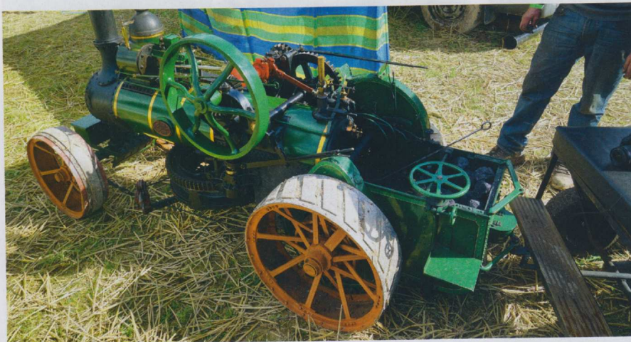
Früheste Pflugmaschine von Fowler im Maßstab 1:3; das Bedienrad am Tender links ist nicht die Bremse sondern das Lenkrad!; Achtung: bei Linksdrehung: Fahrtrichtung rechts! Die Idee mit den verkreuzten Lenkketten war noch unbekannt!
