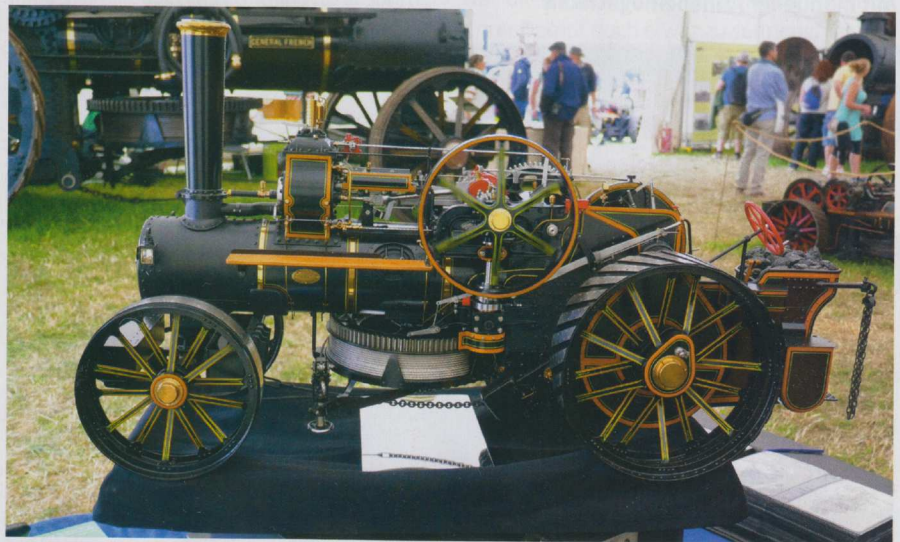
Präsentationsansicht der Maschine vor großer Kulisse von links: Auch bei den allerkleinsten Details stimmt mehr als alles! Sogar der Führungshebel mit seiner Mechanik zur sauberen und sicheren horizontalen Seilwicklung. Auch die Stirnzahnräder hinter dem Schwungrad und die vertikale Welle - präzise bis zum Abwinken. Gleiches für die Seilabführung zum Kippflug. Und die nie gesehenen Öler auf den vorderen herausragenden Verlängerungen der Treibstangen... Hut ab!
