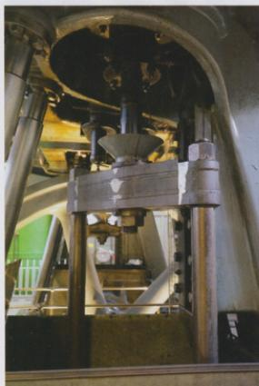
↳ Blick auf den Abtrieb einer Pumpenseite mit zwei Treibstangen, dahinter ein Segment des Schwungrades, dahinter der Abtrieb der anderen Seite
