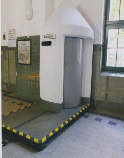
Einmannbunker in Maschinenhaus zur Beobachtung der drei Hauptpumpen und ggf. notwendigen sofortigen Eingreifens bei Störungen im Bombardierungsfall
