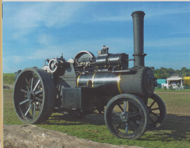
Früh am Morgen die Maschine von vorn rechts. Im Radcenter gut sichtbar die noch fehlende abgenommene Staubkappe auf der Achse am gefressenen rechten Vorderrad.
