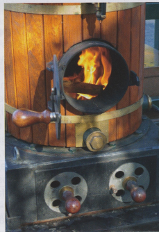
Feuerluke, darunter Abschlämm- und Entleerungsöffnung, darunter die Luftregler.
