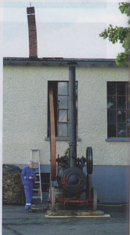
Hier die funktionstüchtige MANN-Dampfwerkstatt von außen mit der Haus-Coloniallokomobile als Antrieb von Lanz Nummer 41537 von 1924.
