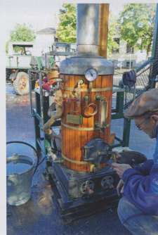
Stehender Kessel, unten Aschekästen und Zuluftrreglung, Handwasserpumpe bei Ausfall der mechanischen Wasserpumpe ganz links, zugelassener Betriebsdruck 8 bar.
