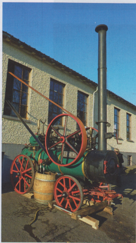
Hier die funktionstüchtige MANN-Dampfwerkstatt von außen mit der Haus-Coloniallokomobile als Antrieb von Lanz Nummer 41537 von 1924.
