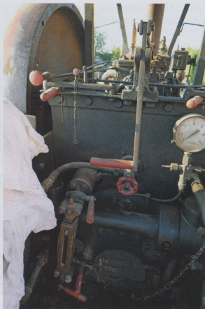
Der Dampfhebel hier im Still der Lokomotiven; der Wasserstandsanzeiger mit seinen Hähnen; die beiden roten Hebel oben rücken wechselseitig das Getriebe ein; das Manometer mit der leicht reduzierten ebenfalls rot gekennzeichneten Höchstdruckanzeige von 10 statt 12 bar.
