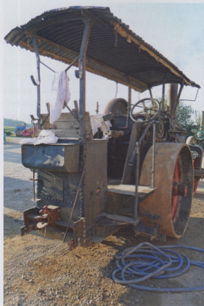
Gut zu sehen die Treppe; erste Stufe unten rechts am Tender; die gewichtsbelasteten Abstreifer am Hinterrad; der große Werkzeugkasten hinten am Tender; das Feuerbesteck und die sicher nachträglich angebrachte Anhängerkupplung.
