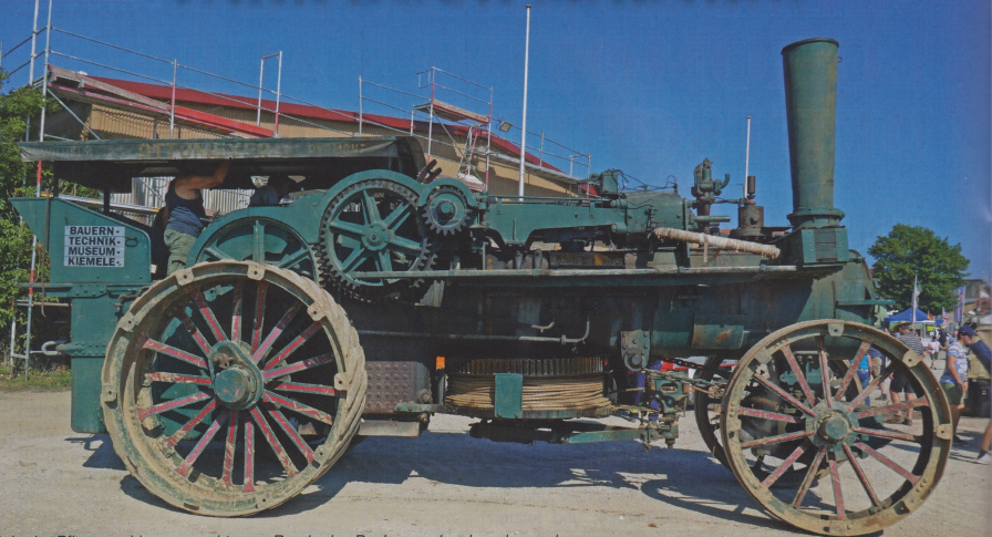
Totale der Pflugmaschine von rechts; am Rande des Daches noch schwach zu erkennen: der Schriftzug Ottomeyer; unter dem Kessel die Trommel für das Zugseil; Pflugmaschinen wurden immer paarweise geliefert; ein Abgang des Zugseiles jeweils pro Maschine einmal nach rechts und die zweite Maschine nach links.
