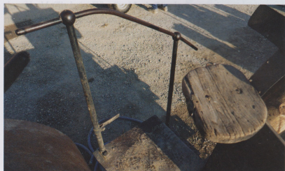
Der holzgefederte originale Fahrersitz mit Rückenlehne und darunter das obere Treppenpodest.
