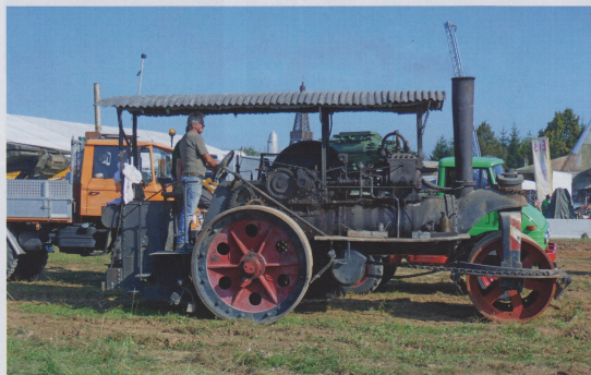
Die rechte Seite der Walze zeigt: Es handelt sich um eine 4-Wellenmaschine; dies ist gut, da der untere Teil des Kreuzkopfes bei Vorwärtsfahrt belastet wird und sich dort das Maschinenöl verschleißmindernd sammelt; hierbei dreht das Schwungrad gegen die Fahrtrichtung! Zu beachten ist außerdem die gute Konstruktion der Lenkschnecke im großen Ölbad vor dem Hinterrad; denn Dampfwalzen sind in der Regel bei minderen Geschwindigkeiten schwierig kraftsparend zu lenken ...
