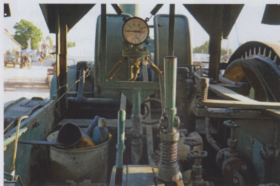
Zustand des Ottomeyer-Pflugmaschinen-Führerstandes in der Anheizphase; Federhebel ist die Umsteuerung; links daneben die Dampfregulierung; Spannungsanzeiger wegen der Erschütterungen während des Betriebes im sicheren Federrahmen.
