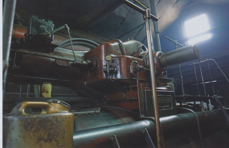
Triebwerke rechte Seite, oben ganz links der Boschöler. Davor die gekapselte Kurbelwelle mit Wellenstumpf. Druckmesser des Öldrucks, Ölleitungen, Fabrikschild.
