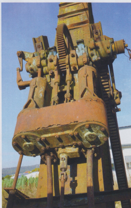
Komplexität in der Höhe am Ausleger: Ansicht der selbst startenden Zwillingsdampfmaschine am Löffelstiel
