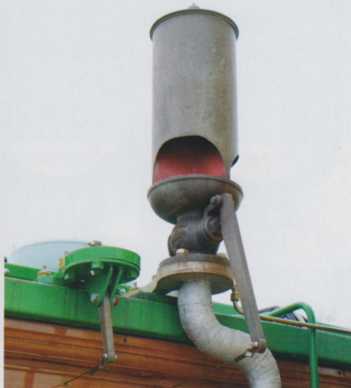
Dampfdreiklangpfeife, tellerförmiges Ventil für Lufthörner
