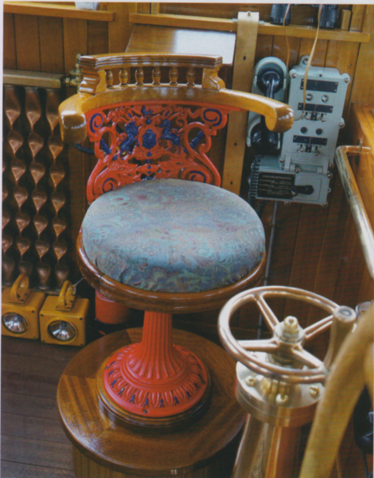
Der Kapitänssessel; links daneben zeitgenössischer Heizkörper aus gefaltetem Kupferrohr; vor dem Sessel der stehende Dampfregler aus Messing
