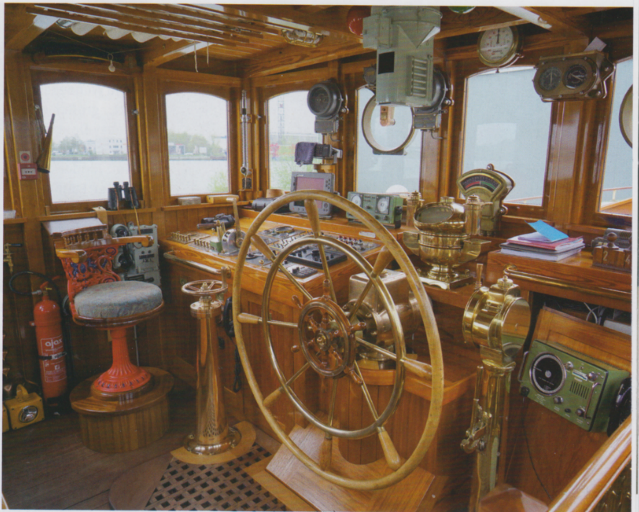
Steuerstand: das kleine Schnellgang Steuerrad im großen, davor der Kasten für Hydrauliksteuerung, davor der Kompass, davor der waageförmige Ruderstandsanzeiger; rechts die drei nummerierten Holzklötze sind zur Vorgabe und Erinnerung des angelegten Kurses, rechts neben Steuerrad der Telegraf zum Maschinisten
