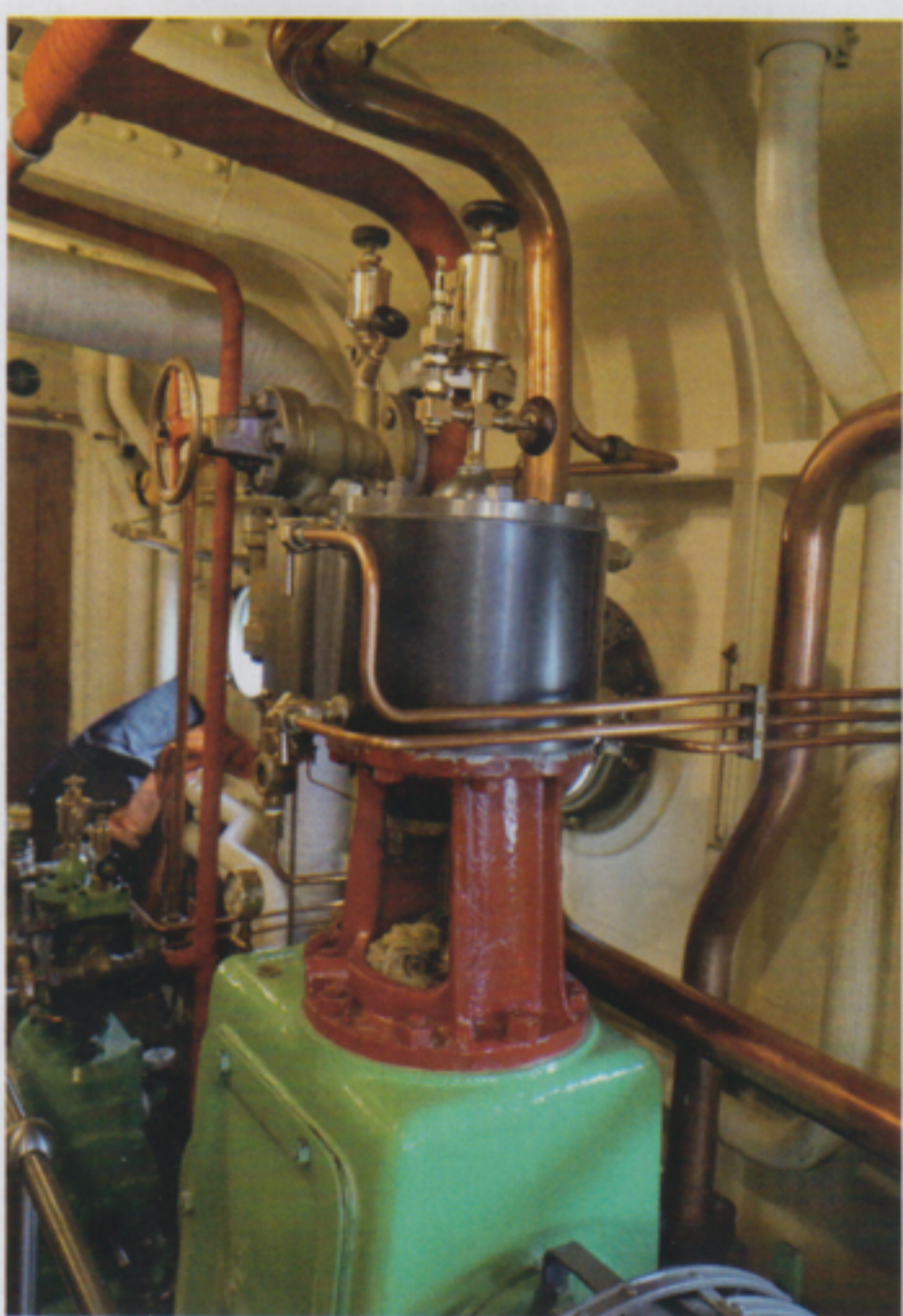
Dampftrieb-Generator, mit Zwangschmierung, Verdrängungsöler oben zur doppelten Sicherheit
