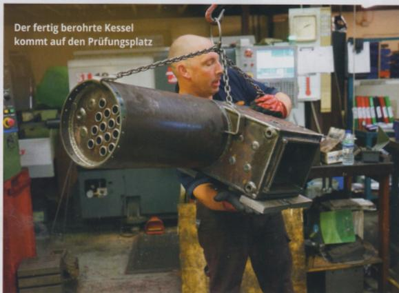
Der fertig berohrte Kessel kommt auf den Prüfungsplatz
