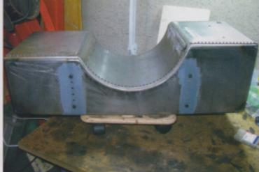
Blick auf die zusammengefügte Teile des Bauchtanks
