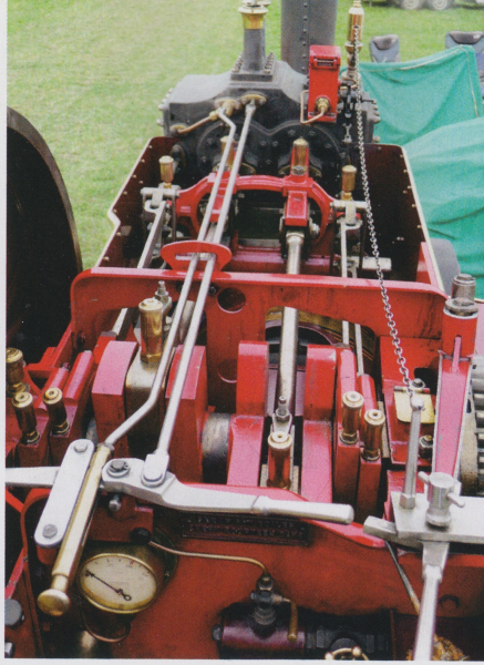
Führerstandsblick: links über Dampfregelung das Anfahrventil zum starken Frischdampfimpuls auf den Niederdruckzylinder; darunter Manometer; zuglassener Betriebsdruck 210 PSI - gut 14 bar; doppelt gekröpfte Kurbelwelle mit ausgleichenden Gegengewichten; über allem die Pfeifenbedienung per Kette; rechts: einer der beiden Ganghebel
