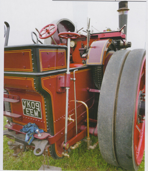
Sicht von hinten rechts: kleines Handrad für die Klotzbremse im rechten Hinterrad; kleiner Hebel zur Injektorjustierung; Kupferleitung der Injektorampfzufuhr; Prüfhähne Tenderwasserstand oben und unten
