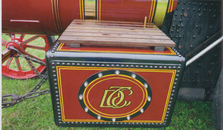
Stolzes kunstvolles Namenslogo in feinsten Ausführung auf linker Bauchtankseite; Trittschutz darauf zur Maschinenpflegebegehung; links unten die beidseitige Lenkkettenjustierung zur Geradeausfahrt; hinten rechts über Tank die Entlüftung
