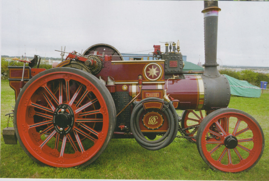
Totale von rechts: Maschinenname Louise; darunter Wasserheber mit Schlauch und Grobteilsiebkopfsaugkugel; links Schrägeleitung der Wassereinspeisung in das Kesselrückschlagventil; vom Zylinder direkt Dampfableitung mit Hahn zum Wasserheber auf Bauchtank rechts; zwischen Rad und Schlauch unten der Kesselwasserablasshahn; zwischen Zylinderblock und Schornstein Bläserhahn mit Zuleitung zum Schornstein; Sicherheitsventile auf Zylinder; roter weitverbreiteter Ratschenöler der Firma Foster; Zahnräder der drei Gänge gut sichtbar
