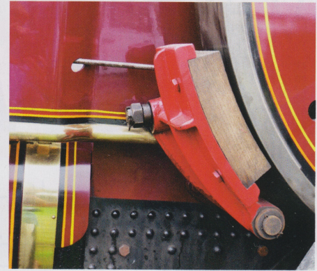
Detail: sorgfältig eingepasster Bremsklotz neben Schwungrad in Offenstellung; schwarzer Flachstahl nach unten zur Luftklappenregulierung; die runde silberne Stange ist die Lenkungswelle; die dünne Stange oben die Zylinderhahnbedienung
