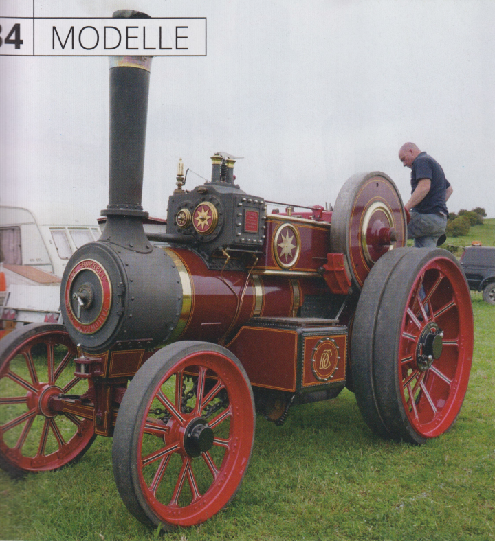
Hinter kleiner Sternscheibe der Hochdruckzylinder; große Sternscheibe der Niederdruckzylinder; kurze Schornsteinverlängerung gegen Sichtbehinderung bei Gegenwind; Vorderachsfederung
