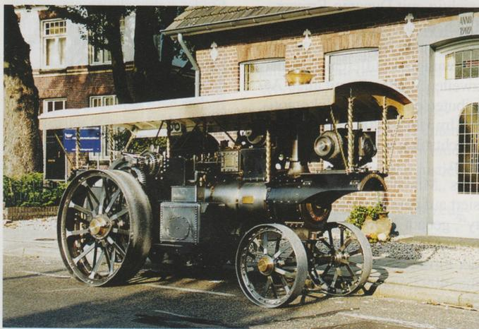
Englisches Parken auf der Hauptstraße in Sevenum. Getrieberadsätze, Wassertank mit Werkzeugkasten, Inspektionsluke, Wassereinfüllstutzen, rechter Schieberkastendeckel, oberer Erreger und vorderer Stromerzeuger sowie die Messgeräte hinten, links unter dem Dach, sind gut zu erkennen. Die Proportionen – die gestreckte Länge der Schaustellermaschine mit vorbildgetreuer Dachhöhe – stimmen, die gewendelten Messingstützen runden das Bild perfekt ab.
