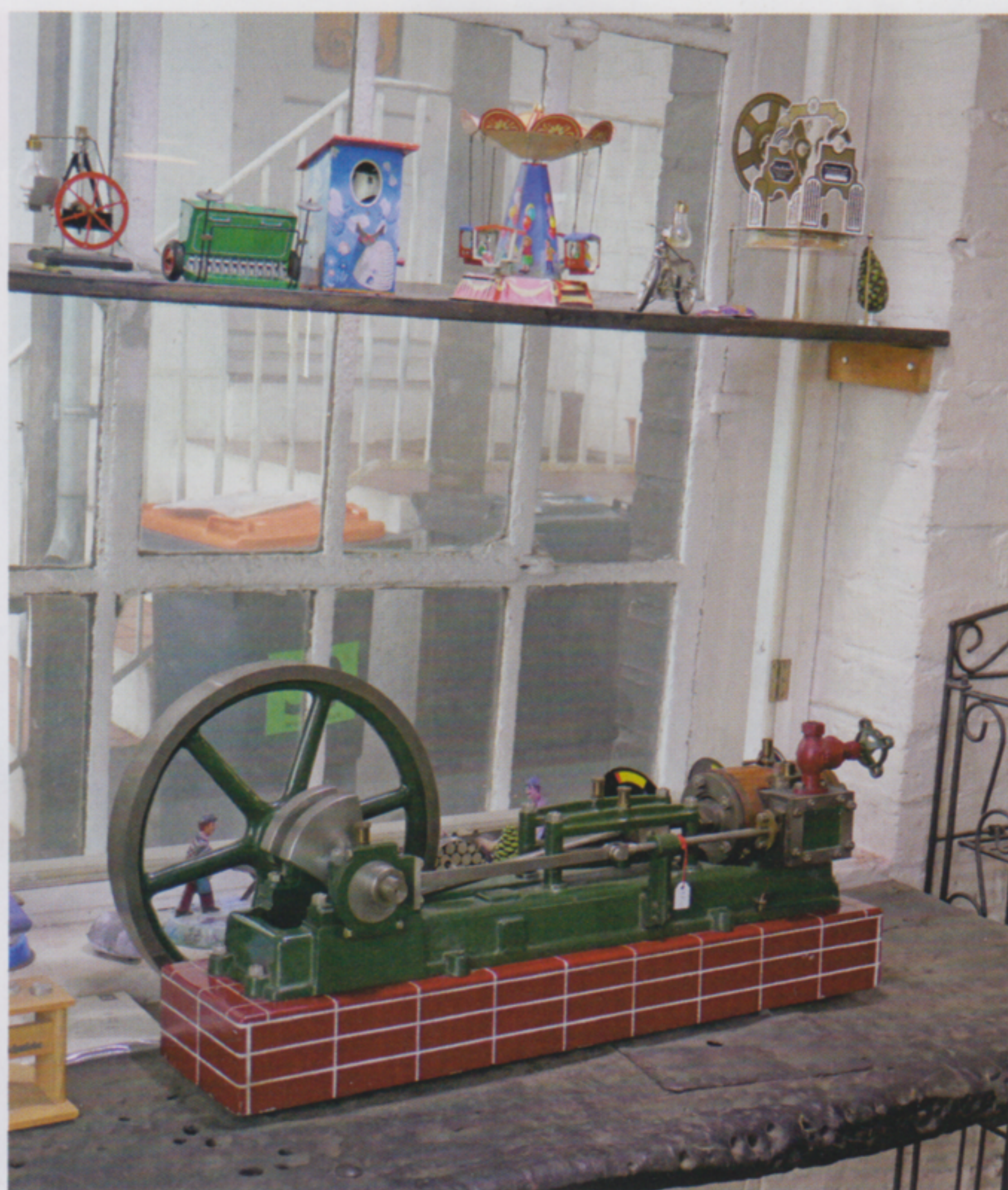
Einfache, liegenden Einzylinder Dampfmaschine für fundamentale Ansprüche ebenso im Bedienungsbereich; Blechspielzeug darüber
