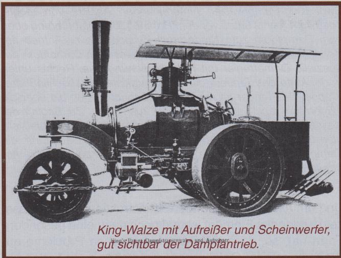
*King-Walze mit Aufreißer und Scheinwerfer, gut sichtbar der Dampftrieb.*
