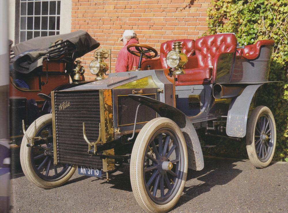
**White Kondensor mit minimalen Betriebswasserverbrauch, Typ D von 1904, Blitzkessel mit kurzer Anheizzeit, hinten links saugender Auspuff für die dadurch beschleunigten Feuergase, im Lenkrad kleines Rad zu Geschwindigkeitsregelung, vorne Halter für die Petroleumlampen**
