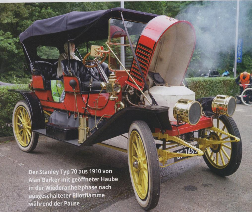
Der Stanley Typ 70 aus 1910 von Alan Barker mit geöffneter Haube in der Wiederanheizphase nach ausgeschalteter Pilotflamme während der Pause
