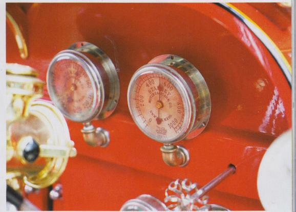
Druckanzeigen: Links: Überdruck im Kraftstofftank, rechts: Druck im Dampfentwickler. Anzeige bedeutet 14,5 Psi entsprechen 1 bar.
