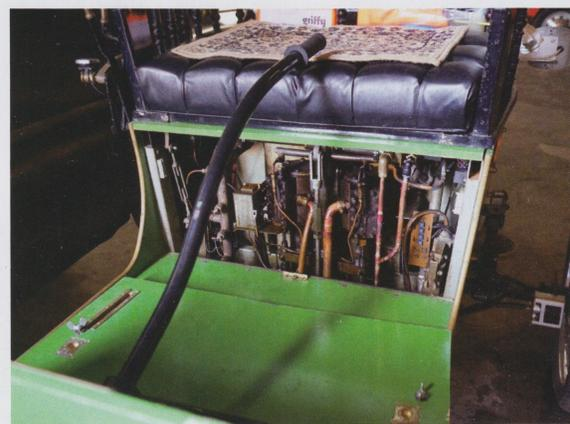
**sichtbar die stehende Zylinder, die elektronische Regelung links der mechanische Öler, und über allem die Lenkstange**
