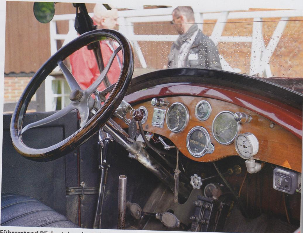
**Führerstand Blick:** stehendes Rohr ist die Wasserpumpe bei Wassermangel, Uhr mit Doppelzeiger für den Treibstoff und Kesseldruck, Fußpedal mit dem Knopf für vor und Rückwärtsfahrt, unter dem Lenkrad Hebel für Fahrregelung, andere Uhr für Treibstoffvorrat und Amperemeter
