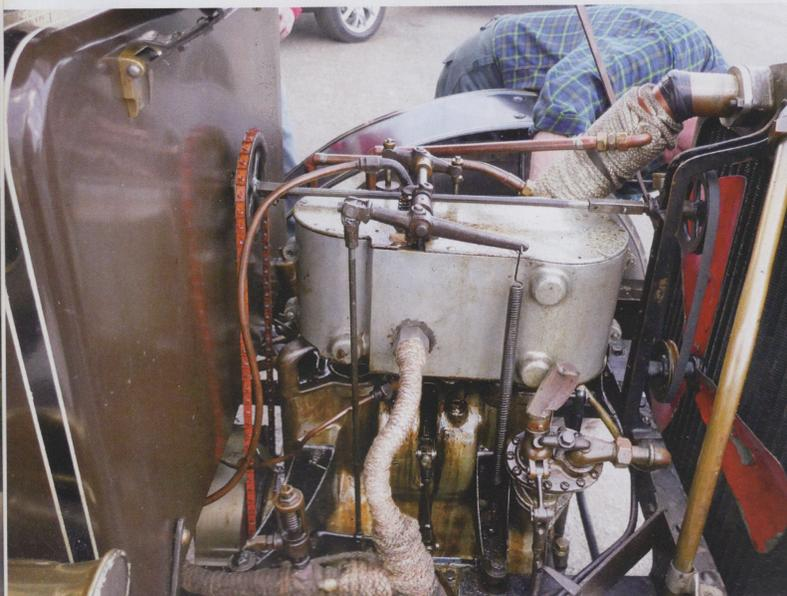
White Dampfmotor, offene Ventilsteuerung, vorn großer Dauerventilator hinter Wasserkühler zur Rückgewinnung von Wasser aus dem Abdampf zur Reichweitenverbesserung
