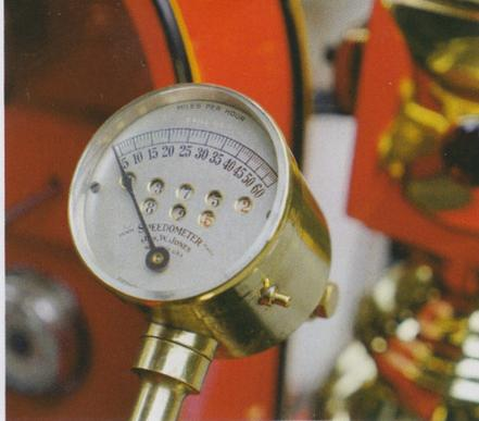
Mechanischer Messing-Geschwindigkeitsmesser und Wegstreckenzähler, Höchstgeschwindigkeit 60 Meilen, Tageskilometerzähler und Gesamtkilometer
