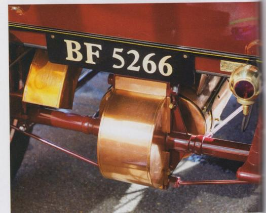
Blick auf die Hinterachse, mittig das Differential unter Kupferverkleidung, links daneben auch unter Kupfer heiße Gase und Abdampf, vor dem Differential die Maschinenverkleidung, beidseitig die Rücklichter
