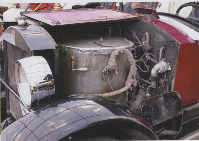
Später Stanley mit Wasserrückgewinnung per Kondensator, Überdruckventil links am Dampfgenerator, geöffnete Klappe zum Anheizen, isolierte Dampfleitung zum Handregler
