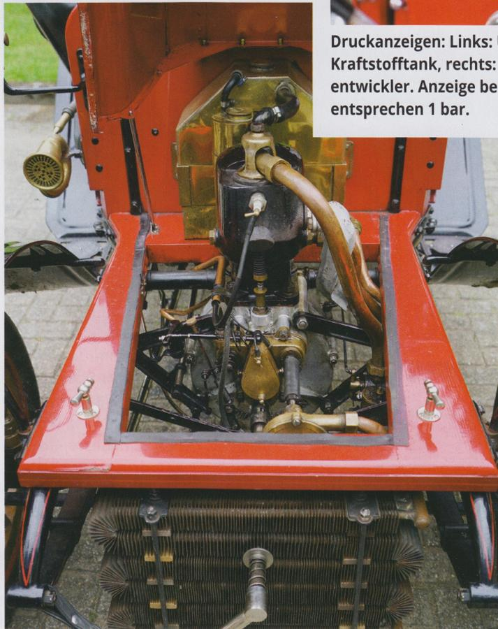
Blick in die Haube des De Dion Bouton PKW Typ Q mit Einzylinder Benzin Explosionsmotor, 600 cm<sup>3</sup>, Schnüffelventil, Schlangenkühler, ein damals weit verbreitetes Modell
