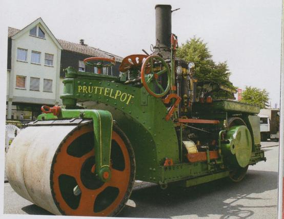
Wappentier Pruttelpot des niederländischen Dampfwalzenclubs; frühe Zweizylinder Verbund Tandemwalze, Stehkessel, Zylinderkopf unter Messingverkleidung, Umsteuerung in Neutralstellung, Fabrikat Kelly, Springfield/USA, Nr.2499 aus 1911
