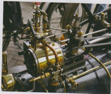
Kann eine kleine aktive finnische Lokomobile im Modell noch funktionsfähiger, graziler und maßstabsgetreuer sein? Schauen Sie auf die Pfeife, den Fliehkraftregler, die Bedienungshebel, den mechanischen Öler, die Leitungsverlegung, den Zylinderfuß, den Dampfregler ... noch Fragen?
