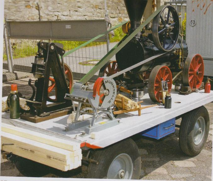
Säge- und Spaltwerk auf fahrbarer Vorführungsplatte. Herzstück eine Lokomobile; die gute Idee zeigen John und Elli aus den Niederlanden: vorn links die Spaltmaschine, rechts die Kreissäge mit Holzschubkarre, maßstabsgetreue Ölkannen für Heißdampf- und Schmieröl
