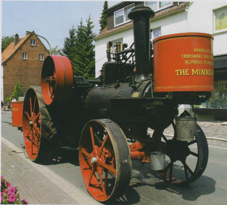
Minneapolis, USA, Einzylinder Dampftraktor, Nr 7559 aus 1911, Wasservorratsbehälter rund und oben vor dem Schornstein!
