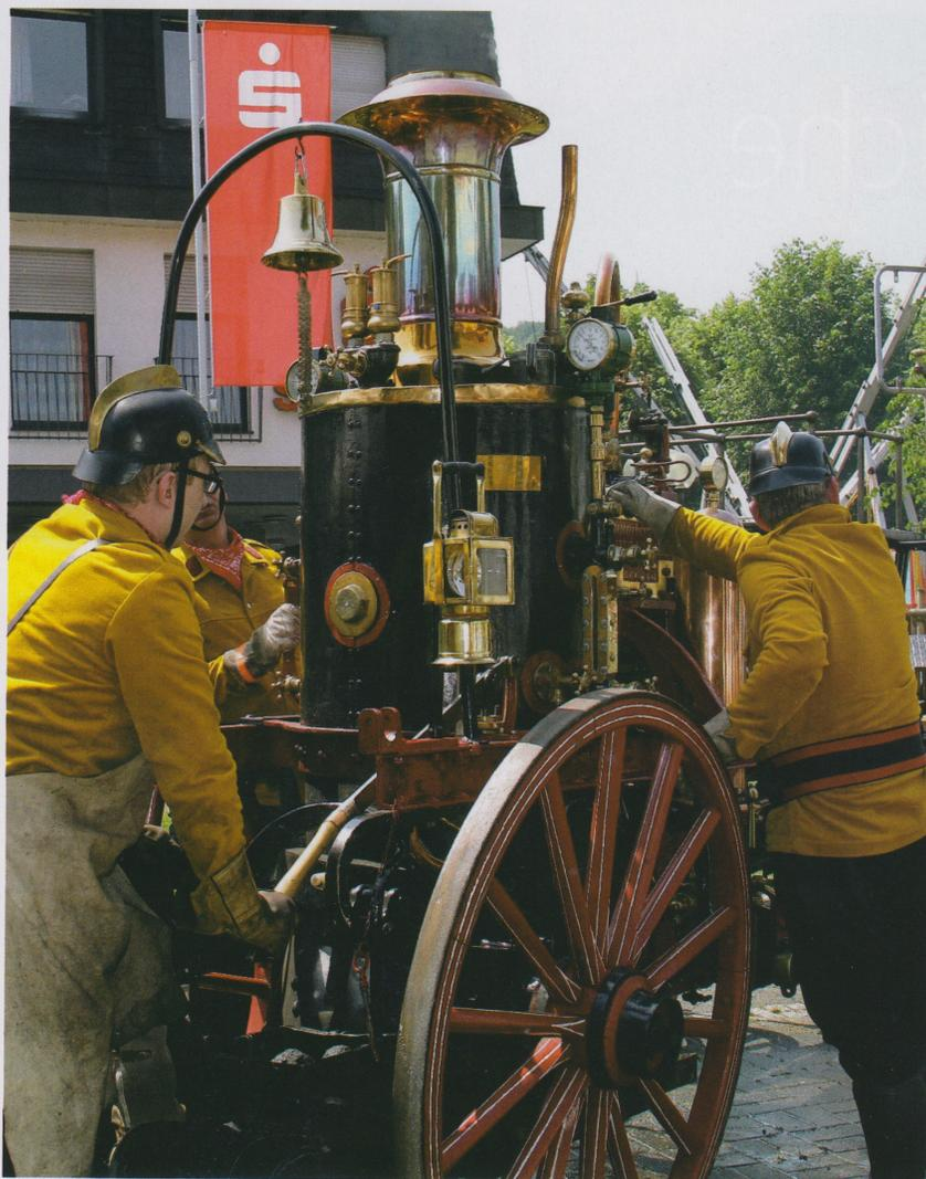
Diese drei von der Feuerspritze sind für den guten Druck und die Funktion verantwortlich: Feuerwehrmann 1: per Handspeisewasserpumpe wird - extrem wichtig - bei Bedarf zusatzgespeist, Mann 2 ölt und wartet, Mann 3 achtet auf genug Feuer unter dem Kessel und Dampfdruck im oberen Bereich ...
