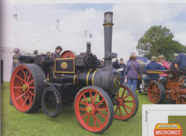
McLaren-Straßenlokomotive ohne Dach, im Maßstab 1:2, Gewicht gut über 3,5 Tonnen, stärkste, schwerste und größte mir bekannte Miniatur in dem Maßstab. Die erste dieser Art wurde innerhalb eines Jahres gebaut ...
