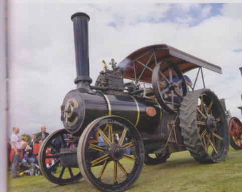
Früher Fowler Dampftraktor, Einzylinder, beachtenswert die aufgeschraubte, auswechselbare Hinterradgummierung
