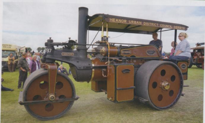
Wallis und Stevens Walze, Doppelhochdruckmaschine, mit kleinem, verkleideten Schwungrad und doppelseitigen Wassertank neben dem Kessel, Segmentlenkung, Eisengusscheiben anstatt Radspeichen
