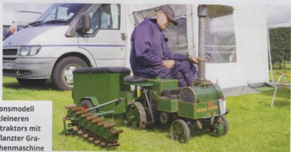
Funktionsmodell eines kleineren Dampftraktors mit angepflanzter Grabenziehmaschine
