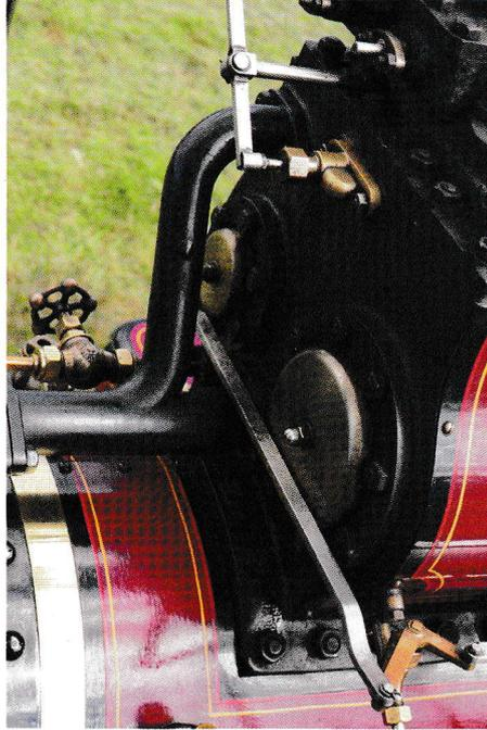
◄ Sicht auf die getrennten Abdampfleitungen im Hochdruckbetrieb, Bläserhahn, gekoppelte Zylinderentwässerung, ganz oben das mittige Dampfwegumschaltventil in Außenansicht
