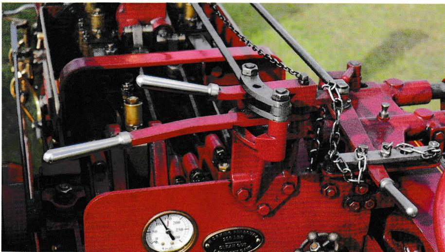
Rechter Ganghebel für das 3-Ganggetriebe mit Arretierungsmöglichkeiten, mittig oben der Umschalthebel Verbund- bzw. Volldruckmaschine, der lange Heber darunter ist der Dampfregler
