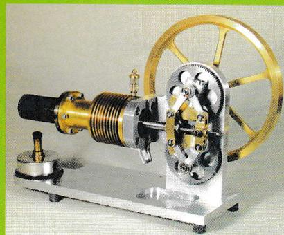
**Bauplan Stirling-Motor mit Rhombentriebwerk**
