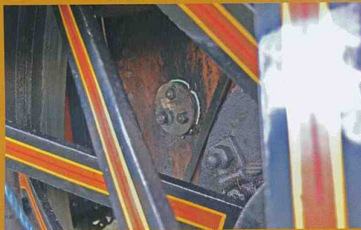
In der Enge: Speiseöffnung, Dämpferhebelstange, Windentrommel mit verschraubtem Seilende
