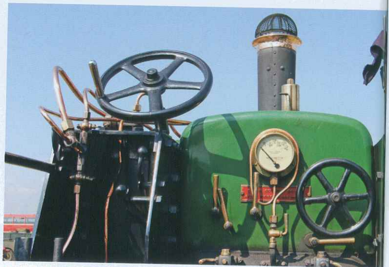
Ganz links untereinander zwei kleine Hähne zur Sprayverteilung vorn und hinten, schwarze Schieberkugeln für die beiden Luftklappen am Aschkasten, Hebel für Bläser, Zischhähne, Injektor und Wasserpumpe, diese versorgt zusammen Kessel und Walzen! Absteller für das Manometer und rechts das Dampfreglerrad, am Rand unten zwei Wasserstandsköpfe.
