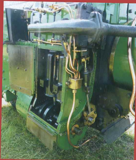
Vor dem Antriebskasten die untersetzte Wasserpumpe, Ableitungen der 4 Zischhähne und des vorderen Schieberkastens in Sammelgefäß zur Entleerung unter den Aschkasten, das dicke Rohr oben ist die Abdampfleitung zum Kamin.
