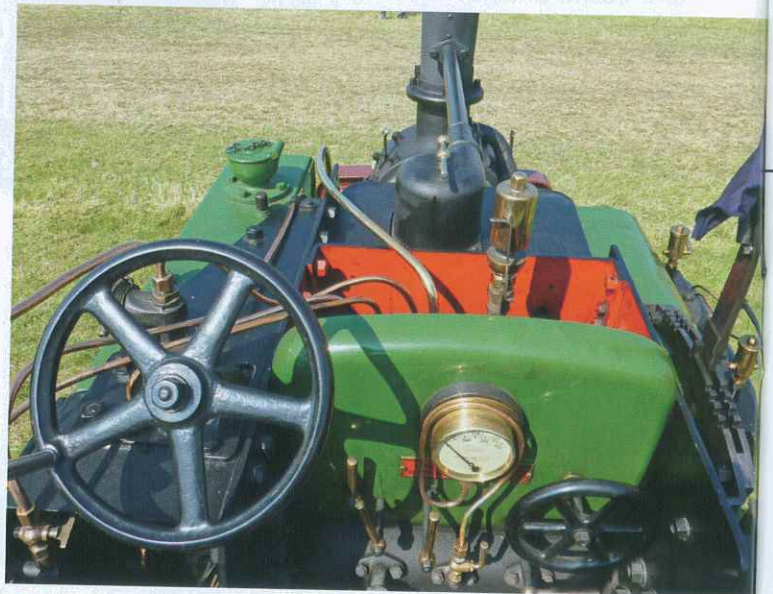
Links vorn Wassereifüllstutzen, Mittig vorn zum Schornstein Abdampfleitung vom Sicherheitsventil, Fahrhebel rechts in Mittelstellung, Ölgefäße auf den Schieberkästen statt Ölpumpe(!), Hinter dem Lenkrad der Wasserheberflansch.
