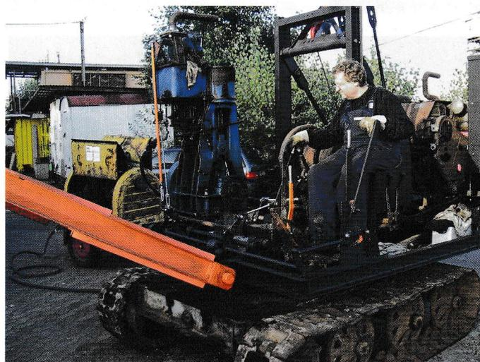
Erster Drucklufttest der montierten Dampfmaschine: Kraft per Kettenübertragung, alter Verbrennungsmotor totgelegt, hier noch am späteren Tank- und Kesselplatz, Sept. 2005.
