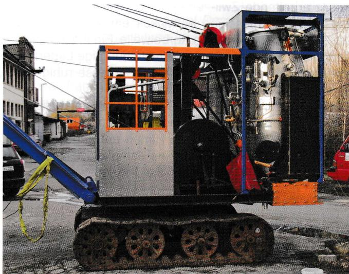
Stehkessel hinter Kabeltrommel betriebsbereit vollständig angeschlossen, Feuertür, Kohlenkasten am Platz, Schaufel mit Holzstil steckt, Wasserstände, Druckanzeiger, kl. Mannloch gut sichtbar im März 2009.
