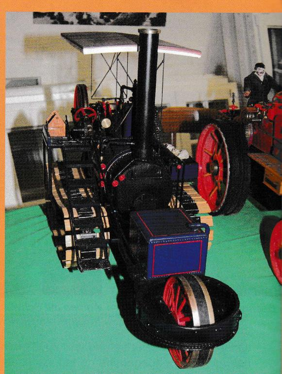
Traktor per Kettenantrieb mit zusätzlichem Steuerrad.
