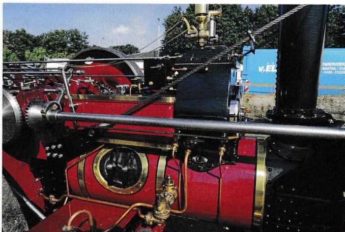
Rechte Seite: Mittelhahn am Zylinderfuß ist das Wasserherberdampfventil, daneben die Entwässerungshähne, darunter der Speisekopf, hinter dem Zylinder sein Öler, am Kessel das Mannloch.
