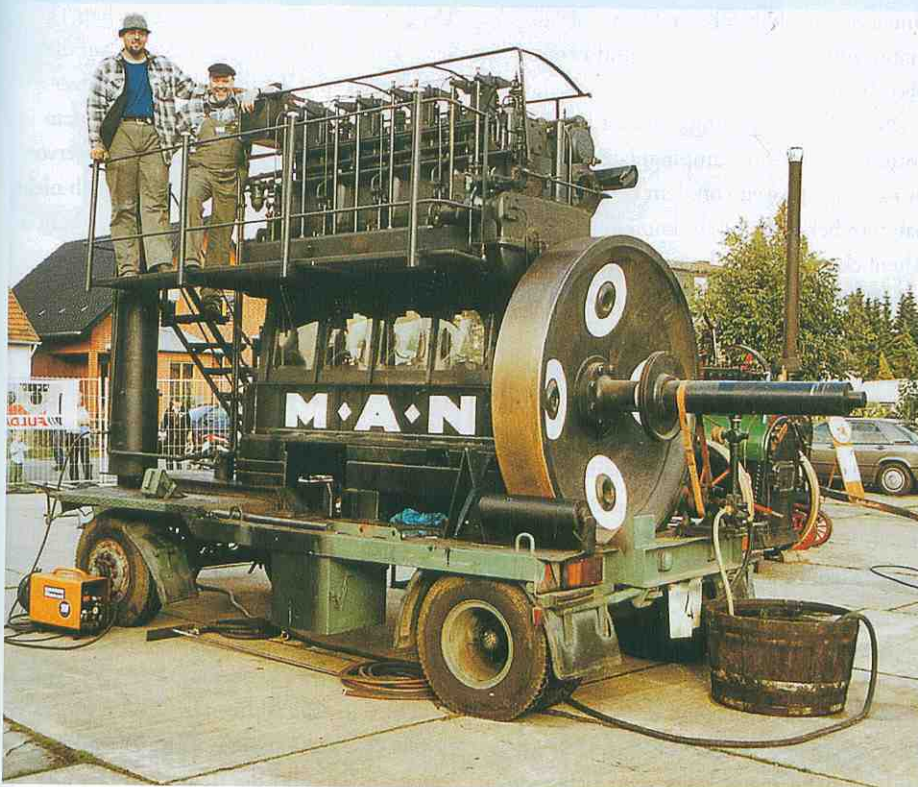
Ein „übersichtlicher“ Vierzylinder-Dieselmotor der Augsburger Firma MAN. Neben den offenen Ventilen stehen die beiden Schmiermaxe. Darunter die Pressluftflasche für den Start und das zum Teil transparente Kurbelgehäuse. Ein gestandenes Schweißgerät zur Beseitigung kleiner Probleme ist auch zu sehen. Vorn, direkt auf der Welle, ein Lederriemen für die provisorische Kühlwasserpumpe.
