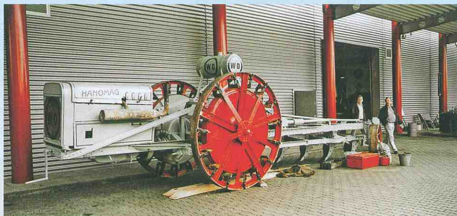
Benzingetriebenes Direktpfluggerät der Firma Hanomag als Versuch aus der Zeit vor dem Ersten Weltkrieg. An den mit Klappspikes versehenen Rädern kann man die Anlehnung an den Dampfflug erkennen.
