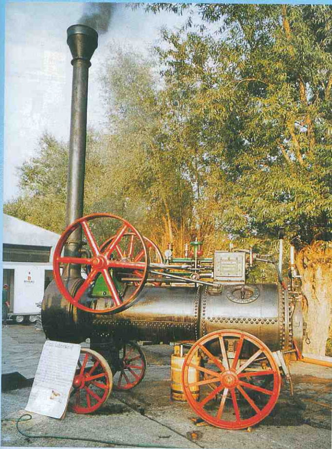
Eine sehr schöne, mit Gefühl restaurierte Lanz-Einzylinder-Lokomotive von 1904 mit ausziehbarem Röhrenkessel, handgefertigtem Schwungrad, Fliehkraftregler und Holzstockbremse auf dem Hinterrad; sie gehört zur Sammlung Gollwitzer nahe der tschechischen Grenze. Hier ist sie in der „dunklen“ Anheizphase zu sehen.
