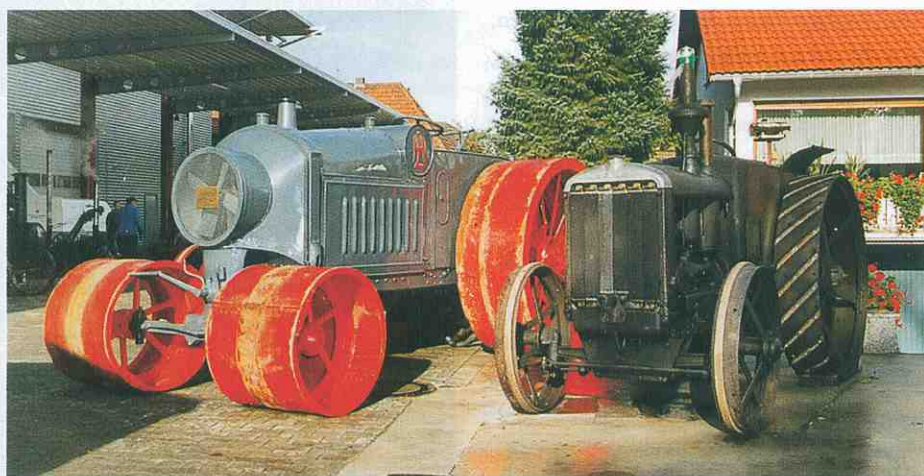
In der Sonne: Landbaumotor von Lanz, System Kőszegi, Baujahr 1921; im Halbschatten: Lanz-Felddank-Zweizylinder mit ähnlichem Baujahr. Beide mit Benzinmotoren versehen, stellen sie die letzte Entwicklungsstufe vor den späteren Bulldog-Typen dar.
