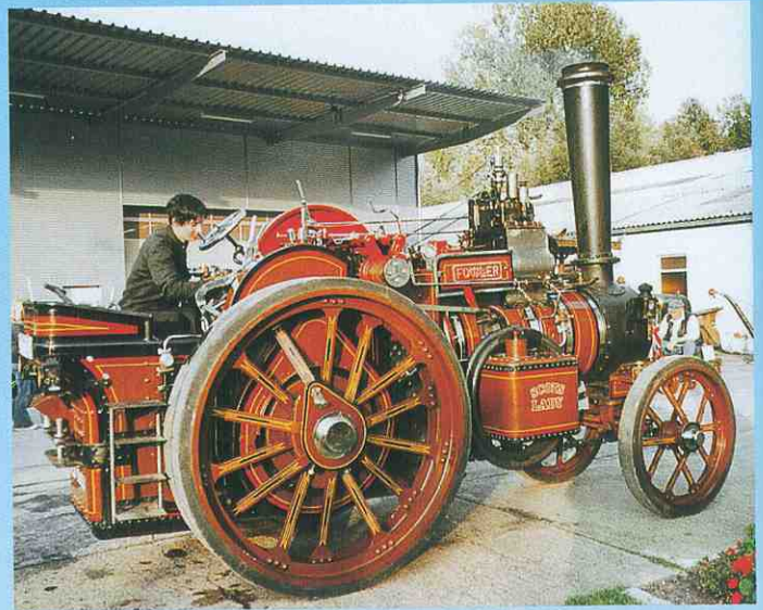
Fowler-Zweizylinder-Verbundmaschine Nr. 21635 mit doppelt gekröpfter Kurbelwelle, zwei Gängen, zusätzlichem Bauchtank, Schlauch für den Wasserheber, Fliehkraftregler über Lederriemen, funktionsfähigen Petroleumlampen – ganz im Stil eines sehr schönen Straßenraktors und eigenhändig vorgestellt von der „schottischen Lady“ nahe unserer Schweizer Grenze: Bea Lauffer.
