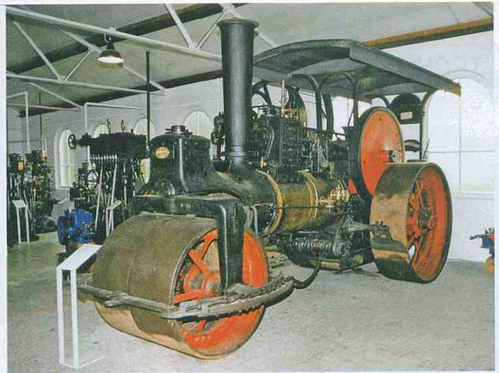
▲ Die gut erhaltene Dampfwalze Nr. 769 vom Typ Ruthemeyer, eine Verbundmaschine auf einer Treibstange aus dem nahen Soest, ist der Nachbau eines Vorbildes der Firma Burrell aus England um 1890
