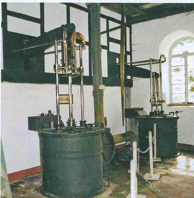
Die beiden Gebläsezylinder werden durch das Wasserrad betrieben
