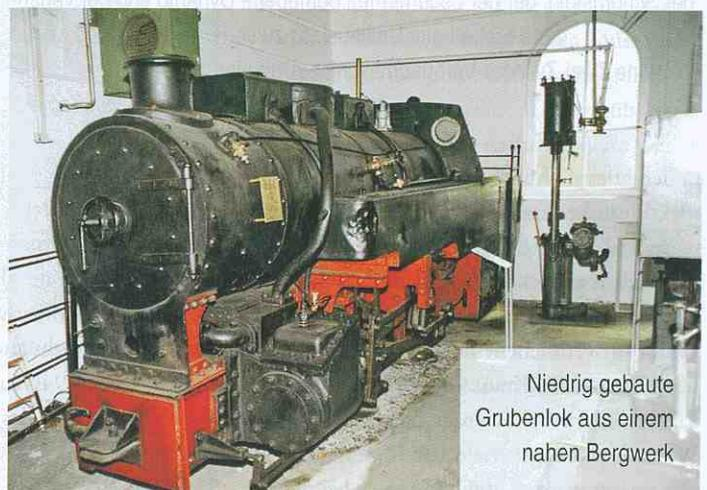
Niedrig gebaute Grubenlok aus einem nahen Bergwerk
