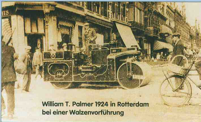
▲ Eine Aveling-and-Porter-Walze (Steam Roller) mit Schiebersteuerung
