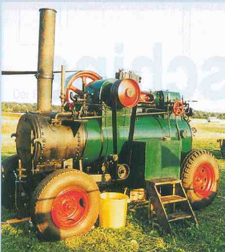
Esterer-Lokomobile 1236 von 1936, ganz nach dem praktischen, dampferfahrenen Geschmack des Vorbesitzers: luftbereifte Traktorstützräder, zwei Boschöler für den Dauerlauf mit guter Schmierung, Treibriemen zur Licht- und Dekorationsantriebsmaschine unter der Kurbelwelle auf dem Fahrzeugrahmen, automatische und handbetriebene Zischhähne, Waschluge über dem Hinterrad, davor der Zusatzwassertank
