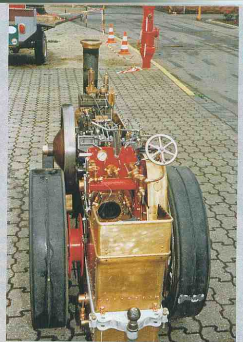
Auf das Wirken John Sandersons zurück geht dieses erschwert zu bauende 2-Zylinder-Modell nach dem Vorbild einer Fowler-Straßenlokomotive
