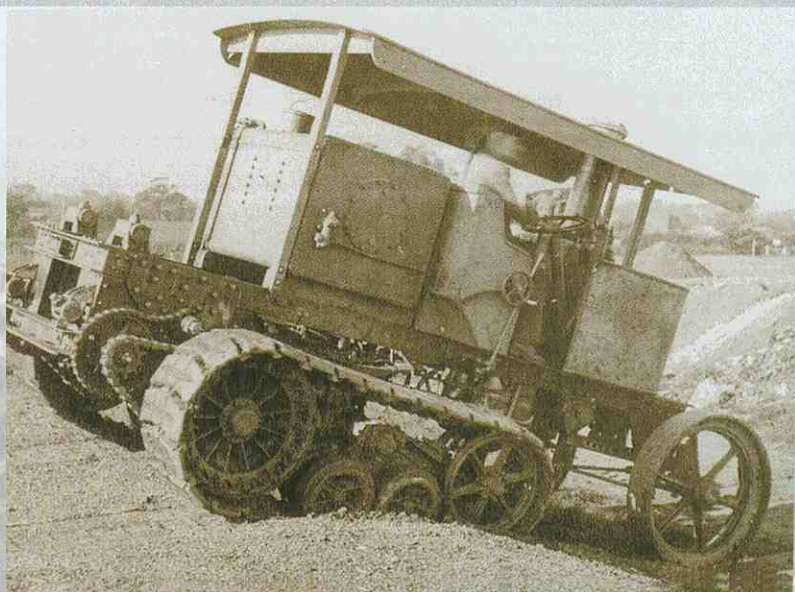
◀ Der Kessel hat einen Brennraum in der vollen Höhe der äußeren Wand, mit sechs Reihen von je fünf durchquerenden Wasserrohren
