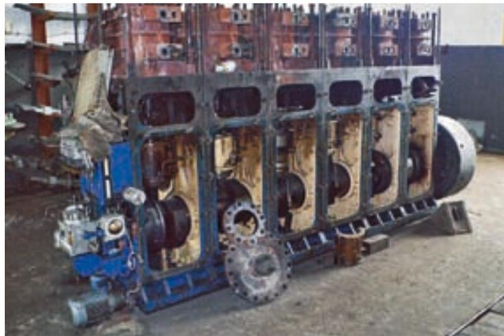
Sechs Spilling-Einzylindermotoren, je zwei Hoch- und zwei Niederdruckzylinder gekoppelt, ergeben dieses Energiebündel, das ohne Ölförderung betrieben wurde und sich gerade in Reparatur befindet
