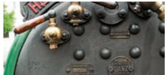
▲ Sehr schön sind die Markierung für den niedrigsten Wasserstand und die beiden Zischhähne zu erkennen. Der hervorragende Zustand der Nieten und Kesselbleche zeigt, dass diese Maschine ständig trockenstand. Die Buchstaben „col“ ganz links deuten auf die Ausführung als Kolonialmaschine hin. Wahrscheinlich ist die Feuerbüchse vergrößert ausgeführt
